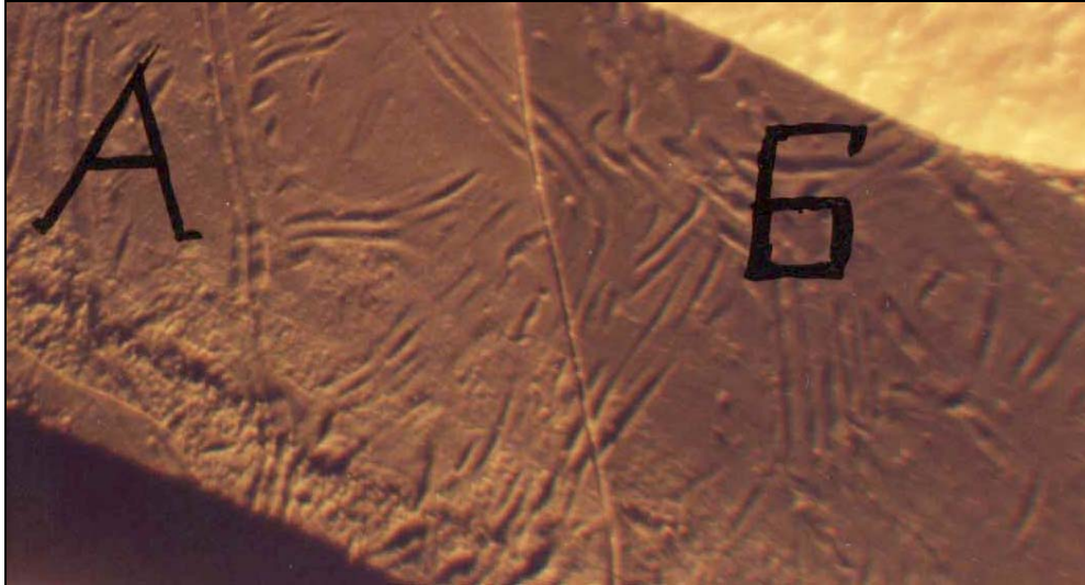
сл.2: Узајамно уклапање рељефних бразди на спољњој површини две љуспице боје. Словом "А" означена љуспица боје са места незгоде, а словом "Б" љуспица боје сумњивог возила.
