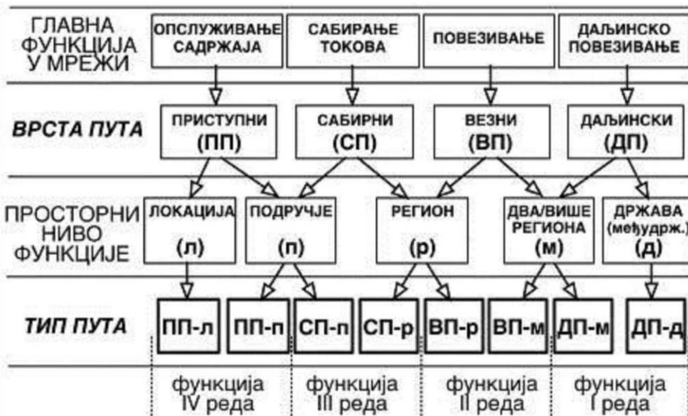
Slika 4-01: Vrste i tipovi puteva prema funkcionalnoj klasifikaciji.
