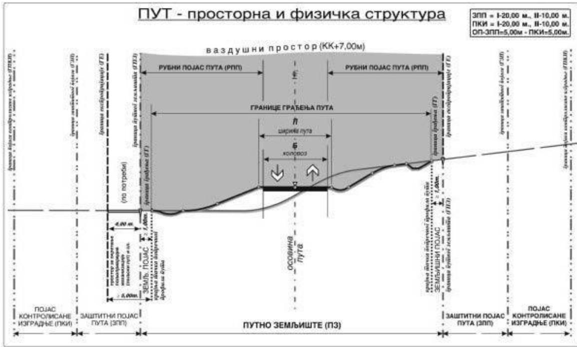
Slika 5-01: Osnovni elementi prostorne i fizičke strukture dvotračnog puta.
