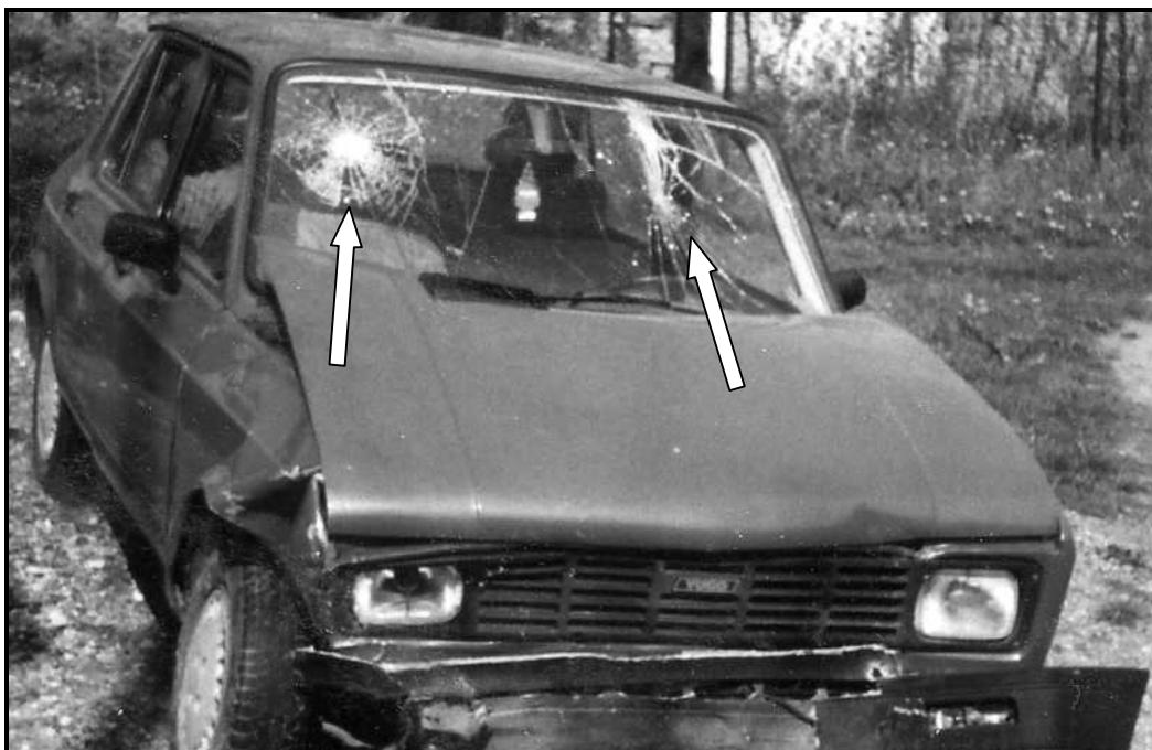
Slika br. 13 – Oštećenja prednjeg vetrobranskog stakla
