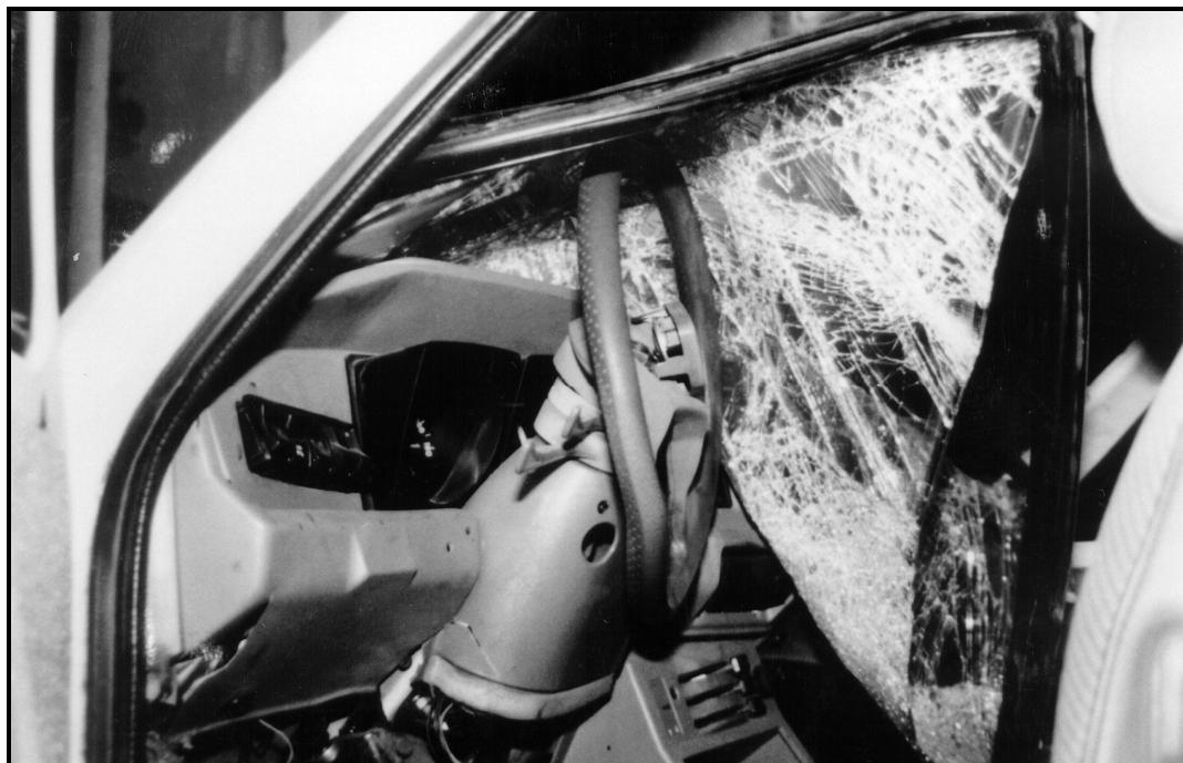
*Slika br. 15 – Oštećenja točka upravljača JUGA*
