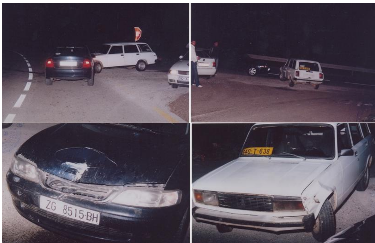
Slika 1. Evidentirane pozicije putničkih automobila nakon nastanka saobraćajne nezgode, i oštećenja putničkih automobila
